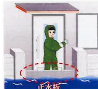
止水板で水の浸入を防ぐ
